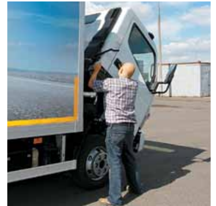
Кабина откидывается со стороны обочины. Грамотное решение!
