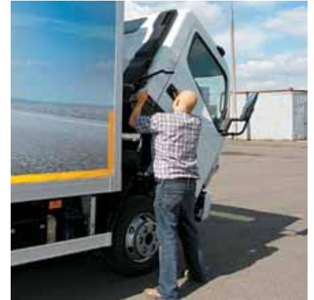
Кабина откидывается со стороны обочины. Грамотное решение!
