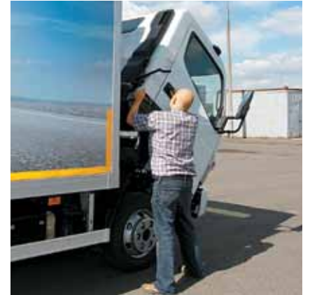
Кабина откидывается со стороны обочины. Грамотное решение!
