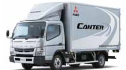
2010 год, восьмое поколение: Canter TX может оснащаться коробкой-роботом и гибридным приводом
