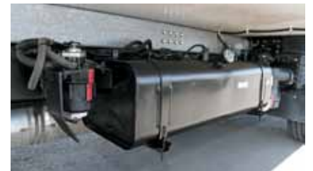
Позади топливного бака — фильтр-«сепар» с защитным «грязеотбойником»
