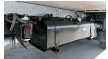
Позади топливного бака — фильтр-«сепар» с защитным «грязеотбойником»
