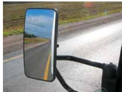
Кузов широкий, а кронштейны зеркал недостаточно длинные: проблемы с обзорностью назад!
