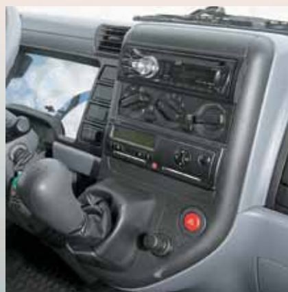
Консоль с джойстиком КПП удачно скомпонована
