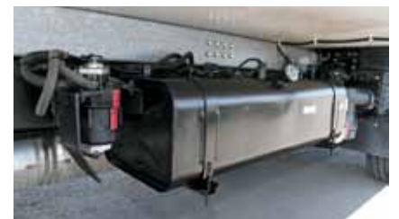
Позади топливного бака — фильтр-«сепар» с защитным «грязеотбойником»
