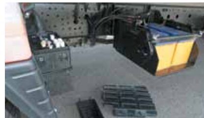
Блок реле — снаружи, аккумуляторы закрыты только сверху, и их крышка уже не держится
