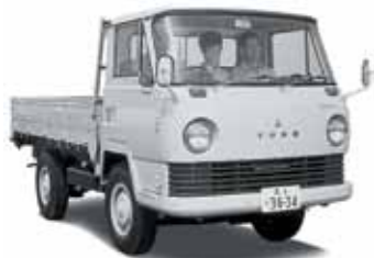
1963 год, первое поколение: Canter был двухтонным и с 68-сильным дизелем
