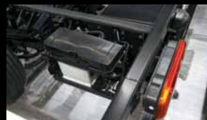
А вот и обычная, 12-вольтовая батарея. Увы, она закрыта только сверху, как и у серийных машин
