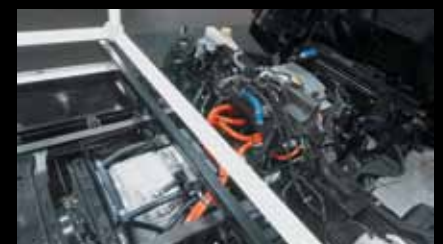
Электромотор расположен на месте коробки передач, а под кабиной — три трансформатора для разных систем грузовика
