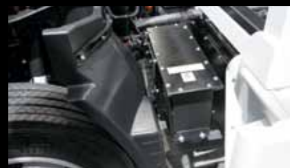
За передними колесами — блоки, автоматически отключающие электросистему в случае аварии
