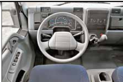
Переключение КП на консоли «торпедо» освобождает проход в кабине
