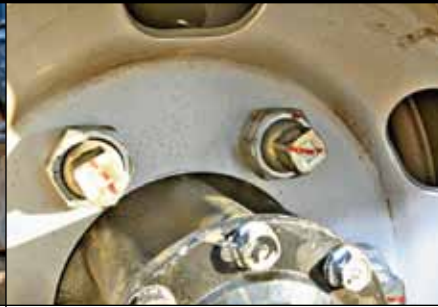
Чтобы отвернуть гайку, удерживая фруторку, изготовим накладки ключ
