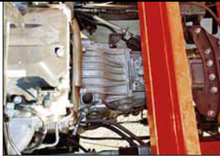
Управление 6-ступенчатой коробкой передач – тросовым приводом
