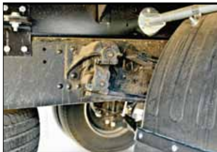
Шарниры задних рессор – с пресс-масленками. Надо шприцевать...
