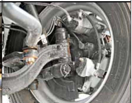
Два однопоршневых суппорта надежнее длинного многопоршневого
