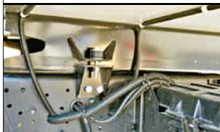
Эластичные крепления надстройки снижают нагрузку на раму шасси
