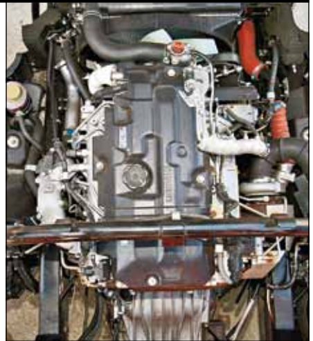
Мотор с двумя уравнивающими валами – редкость на грузовиках
