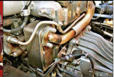
Без такого охладителя газов в системе EGR нормы Евро-4 недостижимы
