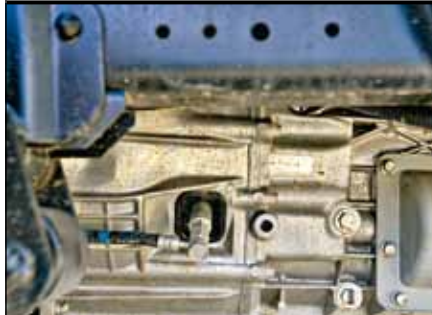
Рабочий цилиндр сцепления внутри – в блоке с выжимным подшипником
