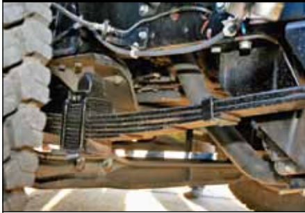
В передних рессорах шарниры не шприцуют: там резиновые втулки
