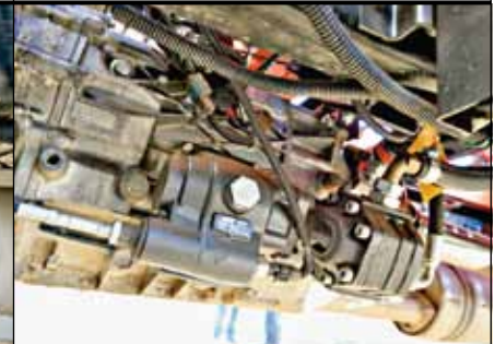
Если надстройка с гидросистемой, на КП ставят КОМ и гидронасос
