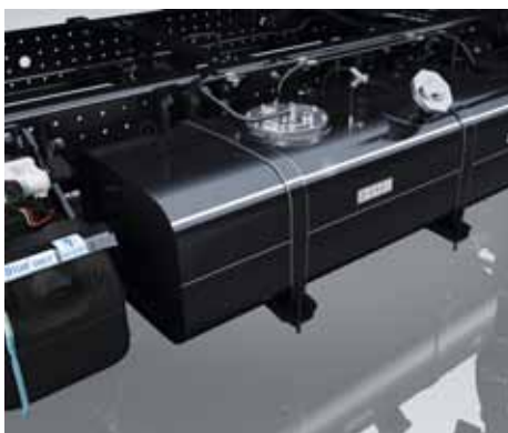
Топливный бак с запираемой крышкой и верхним расположением топливного насоса.
