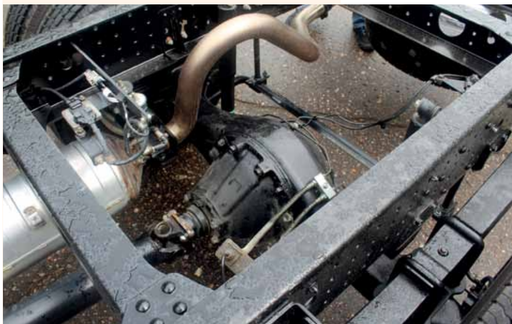
Ведущему мосту уменьшили передаточное отношение главной передачи
