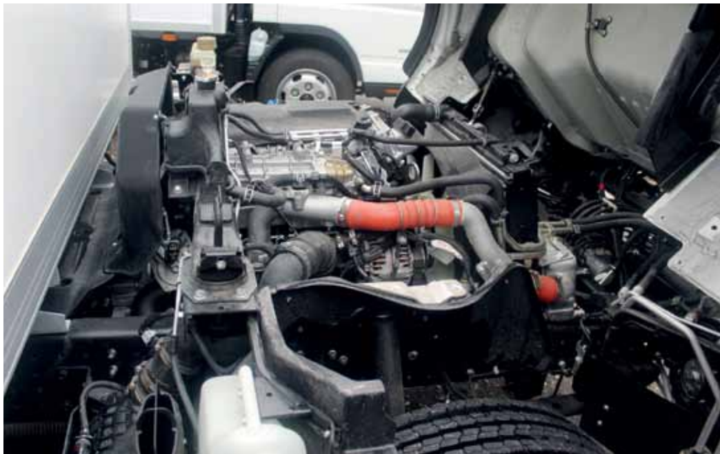
Canter TF оснастили 3-литровым дизелем Mitsubishi Fuso 4P10 мощностью 150 или 175 л.с.
