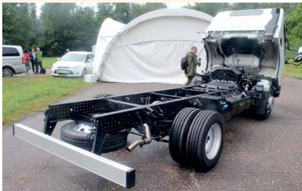
На раме выполнено большое число отверстий для крепления различных устройств и надстроек
