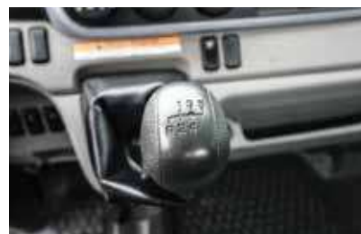
Коробка передач – механическая 5-ступенчатая.
