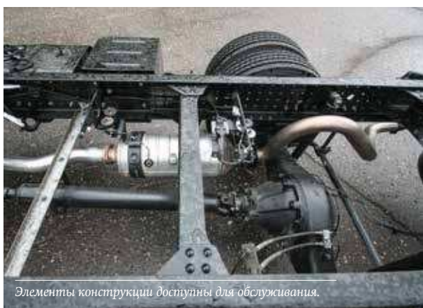
Запасное колесо крепится в заднем свесе.
