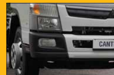
РАЦИОНАЛЬНО. Бампер составной, средняя часть стальная.
