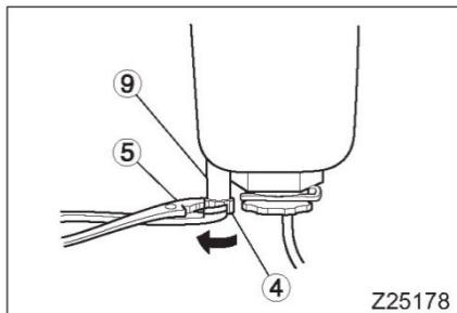
6. Используя ручку, оставьте метки совмещения на корпусе фильтра ⑨ и сливной заглушке ④.
