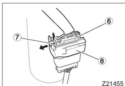
9. Отсоедините коннектор датчика ⑥. Сделайте это после подъёма ручки блокировки коннектора ⑦, а также после вытаскивания верхней части ⑧ коннектора.
