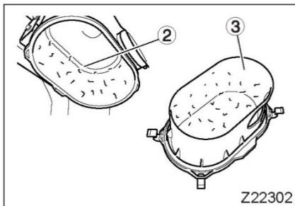
3. Почистите внутреннюю сторону корпуса ② и крышку ③ с помощью тряпки.
