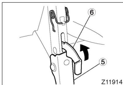
2. Удерживайте ручку наклона для поддержания кабины. Поднимите рычаг блокировки ⑥ и верните держатель кабины ⑤ в исходное положение.
