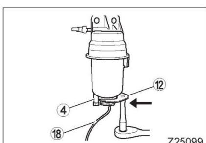
11. Вставьте специальный инструмент ⑯ (доступен отдельно) горизонтально навстречу спускной заглушке ④.
