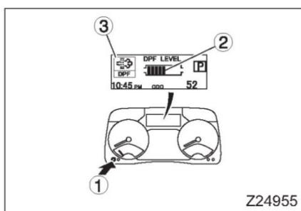
Если вы выбираете монитор дизельного сажевого фильтра на информационном мультидисплее, то вы можете выбрать объём твёрдых частиц, собирающихся в фильтре.
