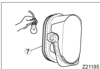
2. Поместите лампочку со стороны уплотнительной прокладки воздушного фильтра, чтобы проверить отсутствие отверстий, позволяющих свету просачиваться через элемент. Та же, проверьте уплотнительную прокладку на предмет трещин или иных повреждений.
