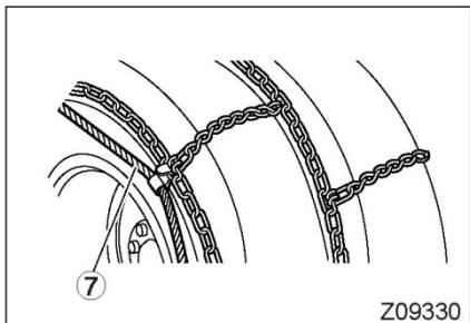
8. Закрепите пружинящие ленты ⑦. Прикрепите крюки пружинящих лент к цепи через равные интервалы, крюки должен смотреть наружу
