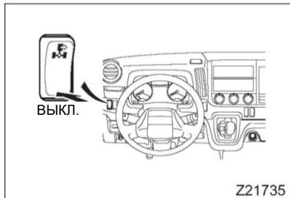
Нажмите на переключатель PTO, чтобы выключить его. Проверьте, что индикаторы **PTO** и **PTO** на информационном мультидисплее погасли.
