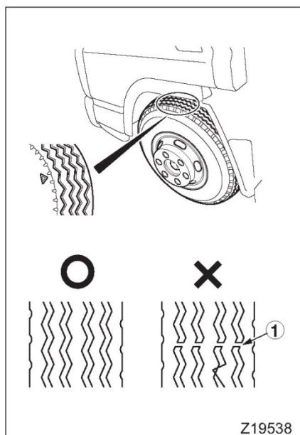
При изнашивании шины, знаки проскальзывания ① (участки прерывания канавок протектора) проявляются на поверхности шины в местах, соответствующим меткам  $\Delta$ . Осуществите замену шин тогда, когда проявляются следы проскальзывания, так как более продолжительное использование опасно.
