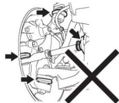
Пылезащитные крышки системы рулевого управления
