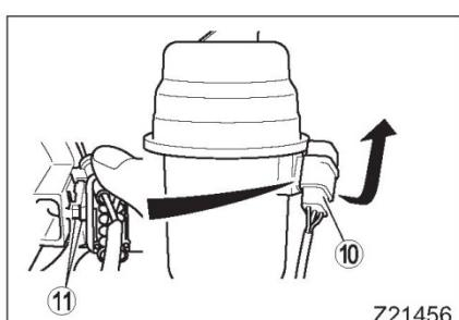
10. Отсоедините коннектор ⑩ от корпуса топливного фильтра ⑨. Сделайте это, потянув нижнюю часть коннектора на себя, чтобы открыть блокиратор ⑪, а затем потяните коннектор прямо вверх.
