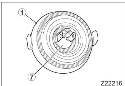
3. Установите крышку ① , нажимая на неё до тех пор, пока конец лампочки ⑦ не будет торчать совсем немного. Нажмите на затемнённую зону при установке крышки.
