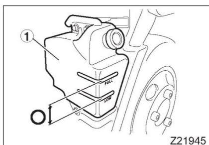
1. Проверьте уровень охлаждающей жидкости, когда он холодный, до запуска двигателя.
