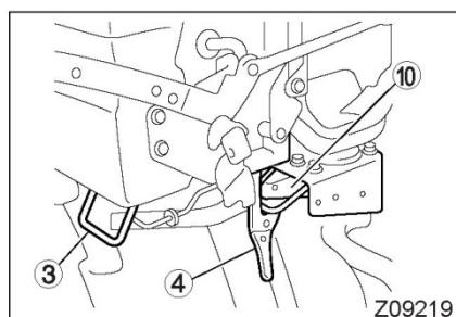
3. Удерживая ручку наклона ⑥, опустите кабину, пока крюк на рычаге С ④ не соединится с креплением кабины ⑩.
