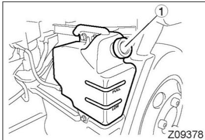
2. Снимите крышку ① с расширительного бачка.
