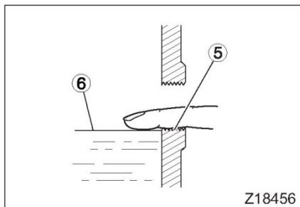
7. Долейте масло через отверстие смотровой крышки, до тех пор, пока оно не достигнет нижней части отверстия.
